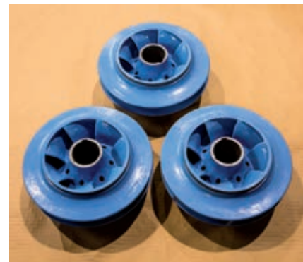
Effizienzsteigerung, beschichtete Laufräder
