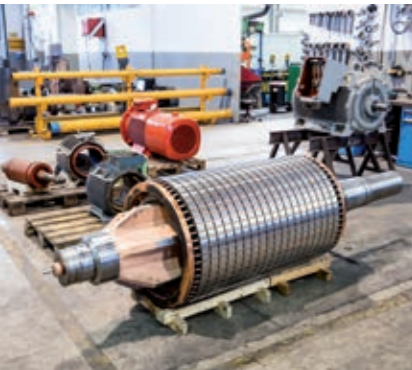
Demontage DS-Motor 1300 kW
